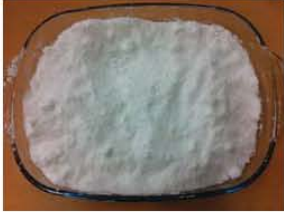
Fig. 3 제조된 2kg LiCl-KCl salt.
