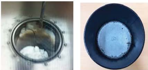
Fig. 4 용해반응기에 장입된 salt 및 물드로 염이송된 salt.
