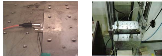
그림 5. 가속도 센서 시험평가
