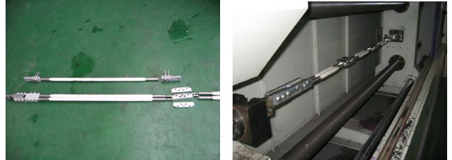
〈그림 6〉 이상용 절연구분장치 시작품 조립 연결 시공모의 사진
