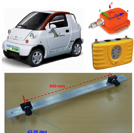
<그림 1> 센서 시스템 상단은 실험에 사용한 이동로봇(전기차), IMU, DGPS이며, 하단은 스테레오 카메라이다
