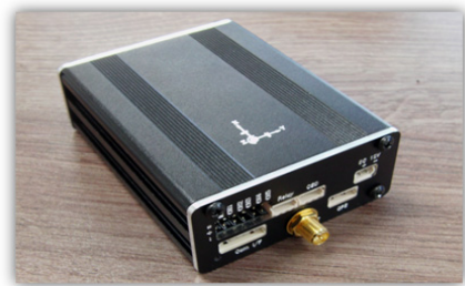
<그림 2> 항법센서 통합 비행제어 시스템의 외형 케이스
