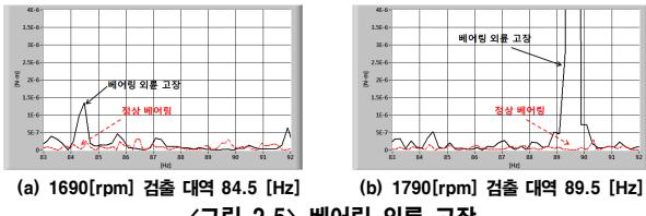
속도 1690[rpm]에서 1790[rpm]까지 측정된 대역 범위는 84.5[Hz]~89.5[Hz]이다. 진폭의 변화가 속도가 증가할수록 진폭도 같이 증가하는 것을 알 수 있었다. 이를 이용하여 각 속도별 주파수 진폭 크기를 평균하여 그 대역을 문턱 값으로 지정하였다. 각 속도별로 지정된 문턱 값의 기준보다 큰 주파수 진폭이 3번 이상 생성될 경우 베어링 외륜 고장으로 판별하여 이를 토대로 고장 진단하였다.
