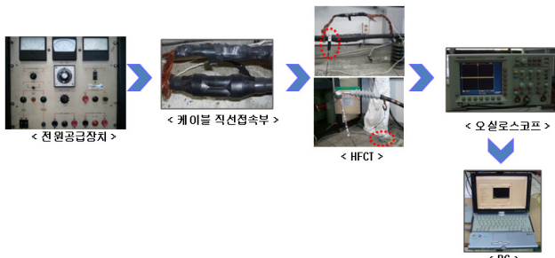
<그림 1> 부분방전 측정 실험구성
