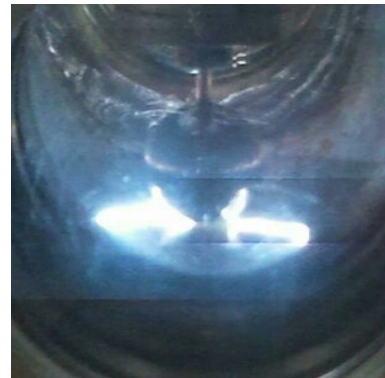
〈사진 2〉 온도저하에 따른 SF 6 의 Weak point
