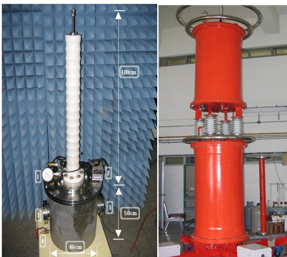
(a) 모의 GIS 챔버 (b) AC 전원장치 〈사진 1〉 실험용 모의 GIS 챔버, AC 300[kV] 전원장치
