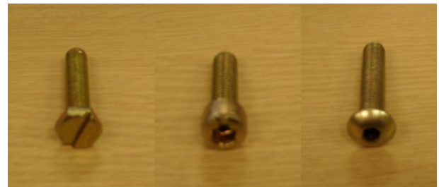
(a) (b) (c) <그림 1> 실험에 사용한 볼트, (a) M8 육각볼트, (b) M8 육각렌치볼트, (c) M8 둥근머리렌치볼트
