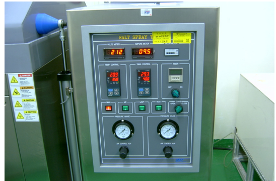
염수분무시험기 온도, 압축공기 Control 패널
