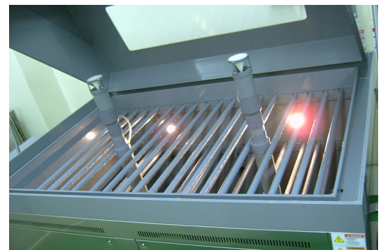
염수분무시험기 Chamber 내부 및 시료거치대
