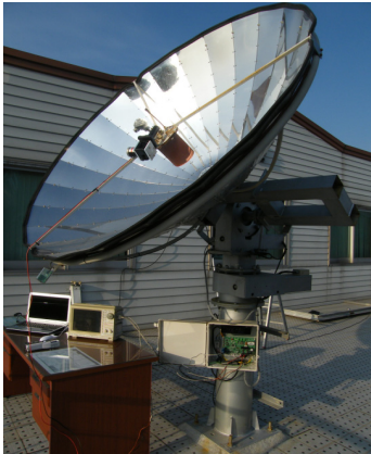
〈그림 1〉 양축 추적식 태양열 발전시스템
