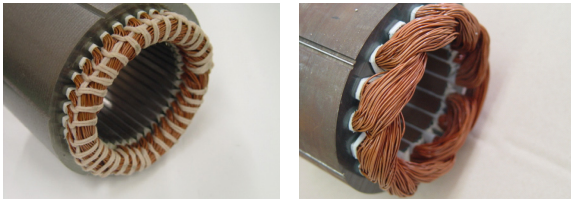
(a) 36슬롯 모델 (Prototype) (b) 18슬롯 모델 (설계모델)
