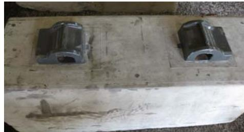
Fig. 2 반복하중시험 후 체결장치
