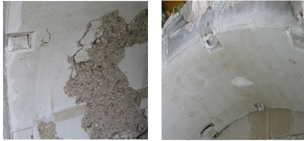
그림 5. 화재 실험 후 터널라이닝 표면(섬유 혼입)
