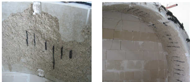
그림 4. 화재 실험 후 터널라이닝 표면(섬유 무혼입)
