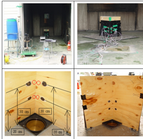
그림 2. 소규모 유사 화재실험 장치
