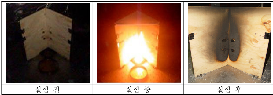
그림 4. 소규모 유사 화재실험 장치를 이용한 연소실험 모습
