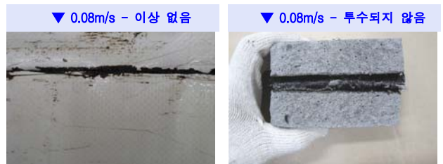
사진 4. 고주파 유도가열 적정 시공성 및 투수성능 시험결과
