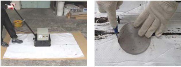
시트 겹침부 고주파 유도가열 현황 겹침부 내정수압 시험용 시편 절단 사진 2. 고주파 유도가열 후 내정수압 시험용 시편 절단
