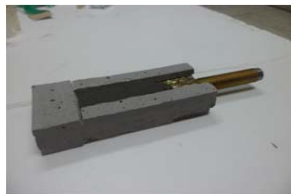
그림 4. 실리콘 단열층 설치 모습
