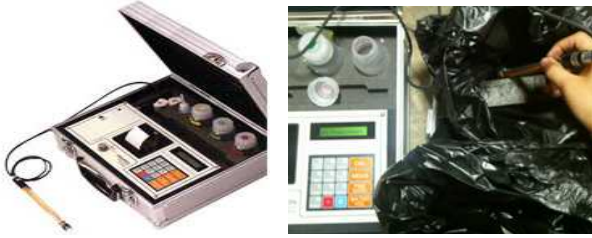
그림 1. 염화물 이온 농도 측정 장치 및 시험 전경
