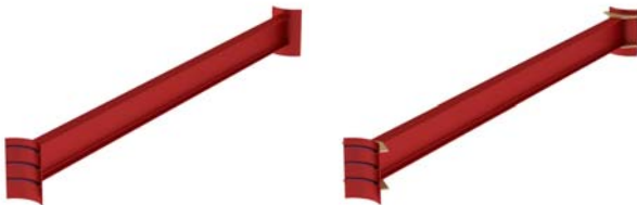
1. 다이아프램이 없는 접합 2. 다이아프램이 있는 접합 그림 10. ES-TD Beam System의 예
