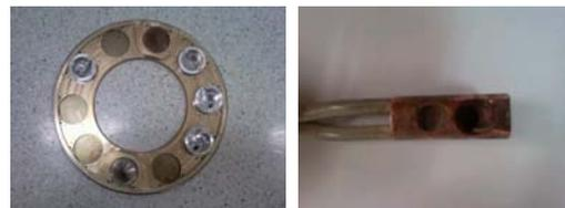
그림 1 폐기 의료용 선형가속기(상) 및 방사선량 측정 대상인 Flattening filter(하·좌) 및 Target(하·우)
