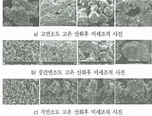
Fig. 3. 조사후 UO_2 소결체 시편의 연소도별 고온 산화 미세조직
