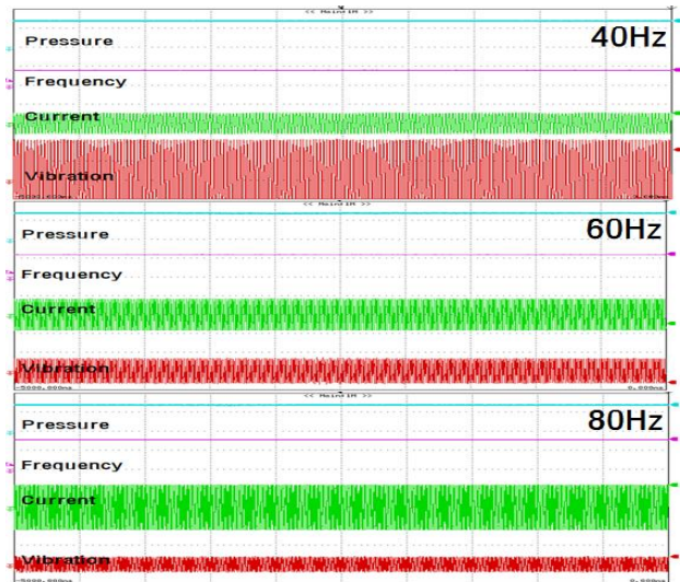
그림 4. 주파수 가변시 다이어프램의 특성 결과 Fig 4. Output characteristics of diaphragm in variable frequency
