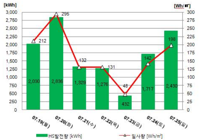
그림 6. 병렬운전적용후 일사량 및 일간발전량 Fig 6. Daily irradiation and generated energy parallel operation
