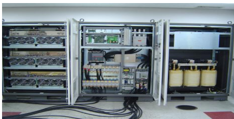
그림 1 제작된 500[kW]급 태양광 발전용 계통연계형 인버터 Fig. 1 The 500[kW] Grid-connected Photovoltaic Inverter
