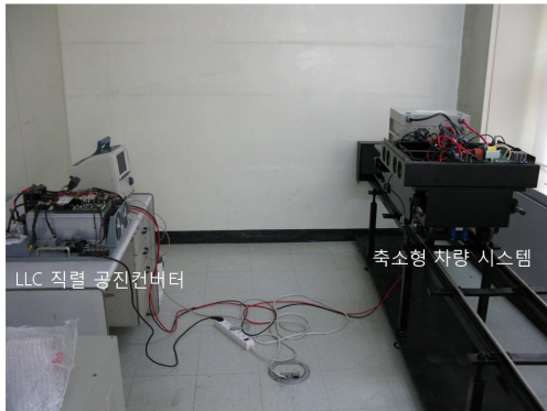
그림 5 유도급전 실험 장비 Fig. 5 Experimental equipments of IPT
