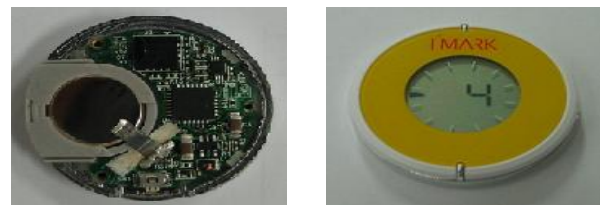
그림 4 2차원 디지털 경사계의 내부 및 외부 사진 실험은 완전히 조립된 제품(I'MARK)을 사용하
