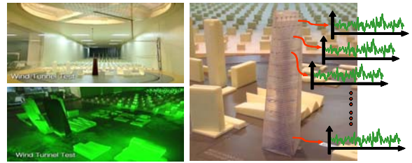
그림 8. 송도 NEATT 및 주변 구조물의 풍동실험 모델
