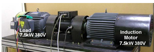
그림 4 Ride-Through 실험 장치
