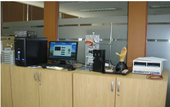
그림 2 제작된 근전의수 내구성 시험기 Fig. 2 Fabricated MHP endurance test equipment
