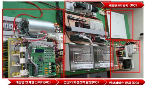
그림 7. 제안한 방식의 태양광 연계형 발전 시스템 Fig. 7 the proposed method for PV generation inverter
