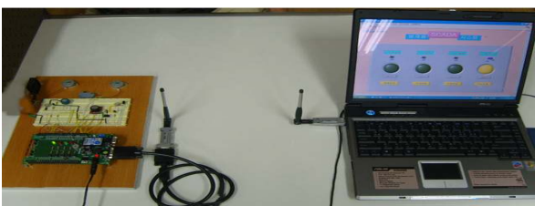
그림 4 원칩형 PLC를 이용한 방재용 자동화시스템 모의실험 장치 Fig. 4 Simulative set of DPAS by using one-chip type PLC
