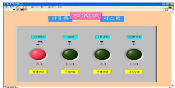
그림 6 화재발생시 경보 및 스프링클러 동작 모니터링 화면 Fig. 6 Monitoring screen for fire alarm and sprinkler operation
