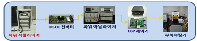
그림 4 제어기 성능 실험 구성 Fig 4 Composition of Controller performance test
