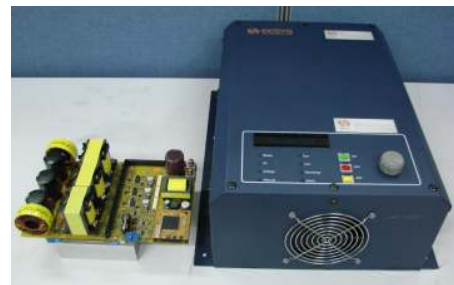
그림 5 연료전지 발전 시스템 시작품 하드웨어 Fig. 5 Prototype hardware for fuelcell system
