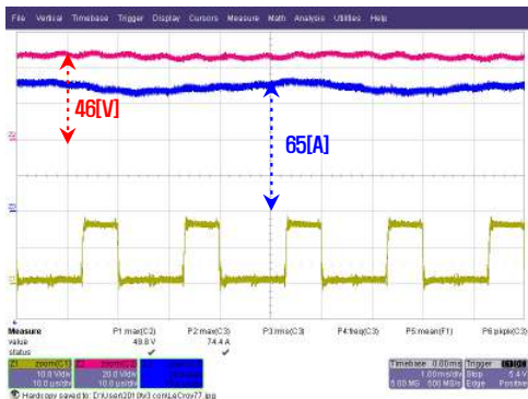
그림 8 가상 연료전지 출력 전압/전류 Fig. 8 Voltage and current of fuelcell simulator (20V/div, 20A/div, 10 \mu s/div)
