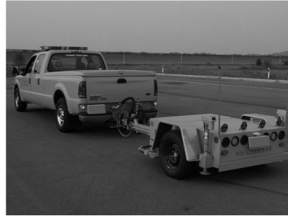
그림 2. 자동식 미끄럼측정 장비(PFT)
