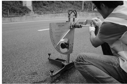
그림 5. BPT를 이용한 미끄럼저항성 측정
