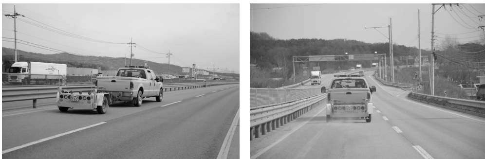
그림 3. PFT 장비를 이용한 미끄럼저항성 측정
