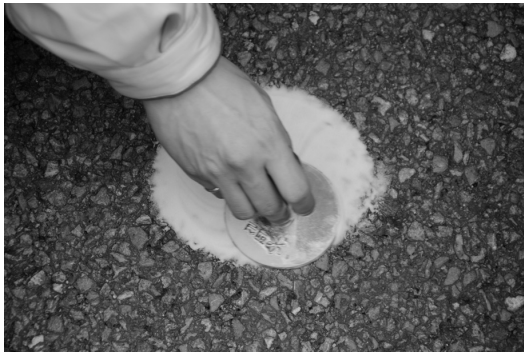
그림 4. Sand Patch Method에 의한 MTD 측정
