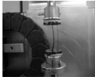
그림 5. Strain Sweep 시험 끝난 후
