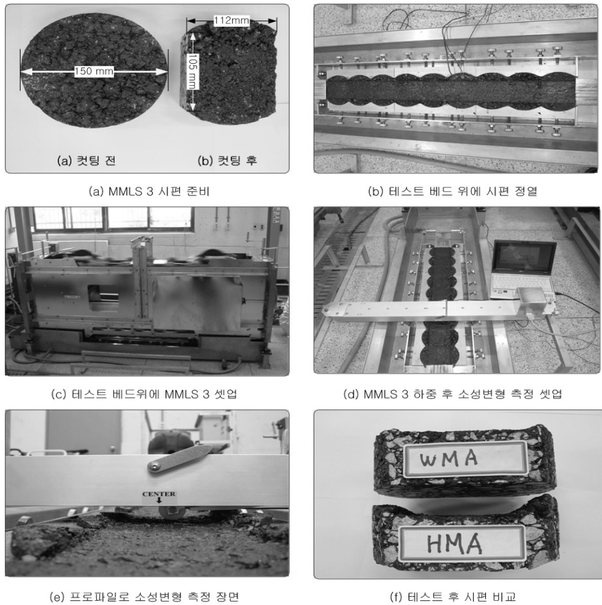
그림 2. MMLS 3 테스트 과정
