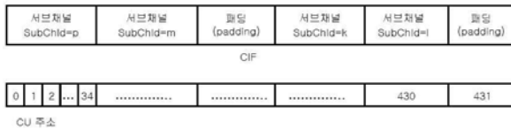
그림 3. 전송 프레임 구조 (B모드, 향상 계층)
