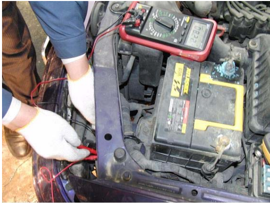
〈그림 4-11〉 전압, 전류 측정
