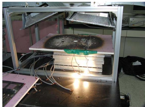
〈그림 4-18〉 복사열을 이용한 자동차 배선의 내열 실험 구성
