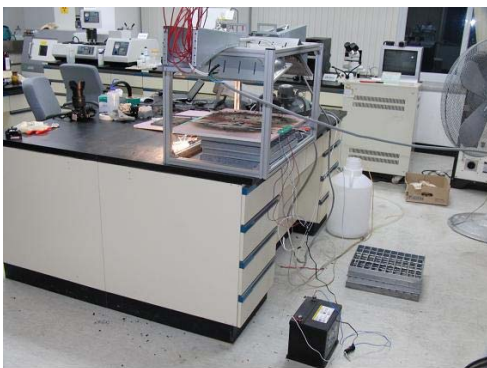
〈그림 4-18〉 복사열을 이용한 자동차 배선의 내열 실험 구성
