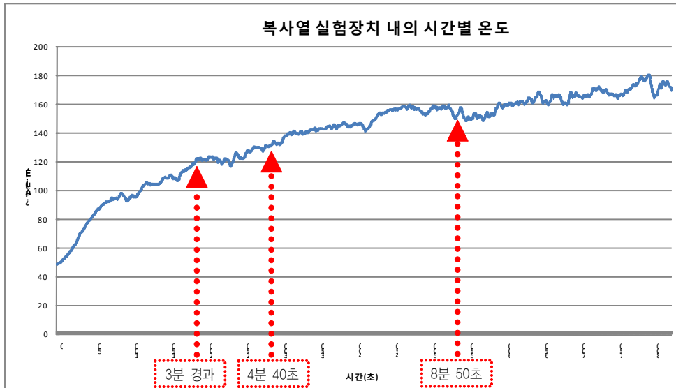
〈그림 4-23〉 복사열 실험장치 내의 시간에 따른 온도 변화
