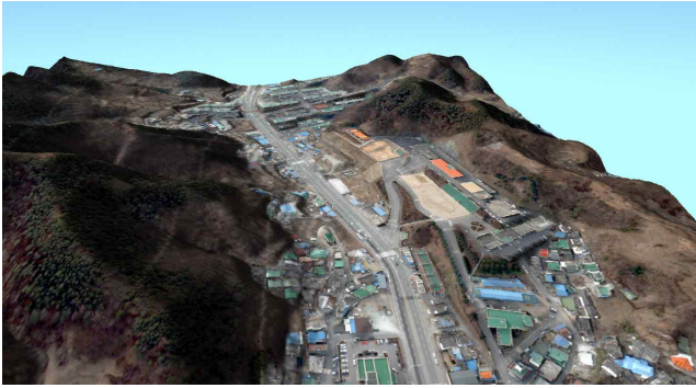
[그림 10] DEM과 정사영상을 이용한 지형모델링
