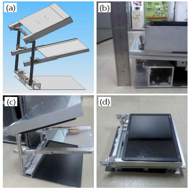
그림 3 설계 및 제작된 워크벤치 시스템. (a) 설계-펼침 (b) 제작-치수 (c) 제작-펼침 (d) 제작-접힘.
