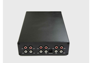
그림6. 10.2채널 Audio 출력(사용자 Interactive 음원 재생을 위한 다채널 실감 Audio 재생기 후면)
