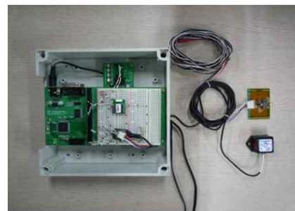
Fig. 1 개발된 자극 시점 검출 센서 시스템
