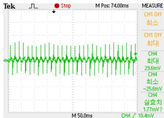
그림 4. 배터리 전원을 이용한 X선 기기의 입력전류
