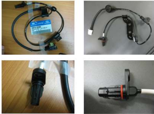
그림 1. YF Sonata 차륜 속도센서 외형
