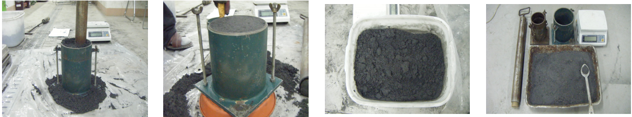
(a) 시료준비 (b) 시험기구전경 (c) 다짐시험실시 (d)다짐완료
