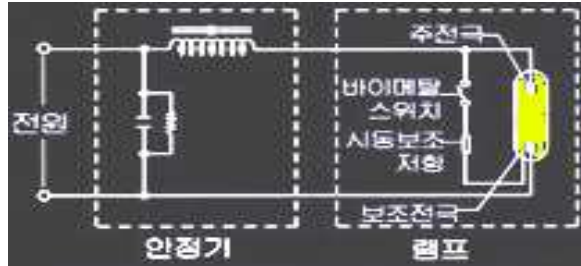
<그림 6> Auxiliary electrode utilization in lighting circuitry
