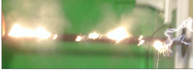
그림 7. 연면방전에 의한 화재 진행
