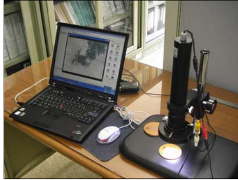
그림 2. 접촉각 측정시스템의 외형을 나타낸 것이다.
