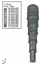
그림 2. 텔레스코픽 튜브셋의 구조해석 결과
