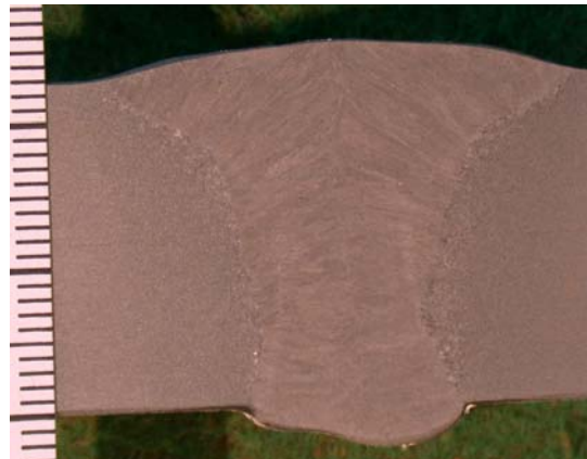
Fig. 7 일면 SAW 용접부 단면 형상
