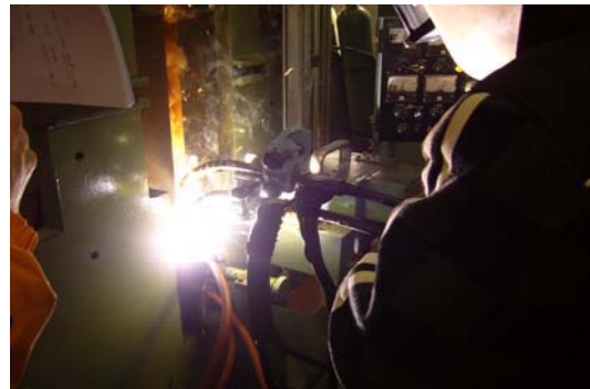
Fig. 14 대입열 2 전극 EGW용접 작업
