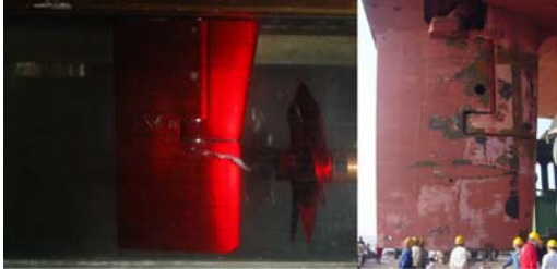
Fig. 1 Rudder Cavitation 모형시험 및 침식사례
